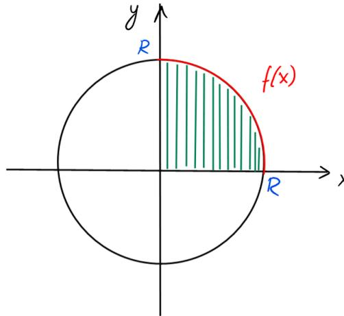
L'équation du cercle est  $x^2 + y^2 = R^2$ , et pour  $x, y \geq 0$ , on a
