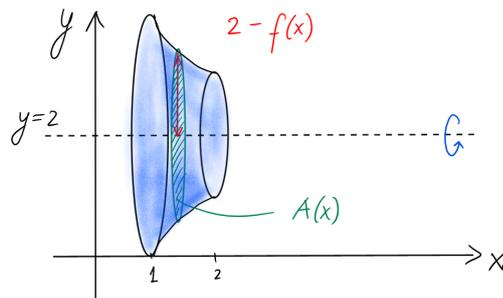
Dans ce cas, la section est un disque de rayon égal à  $2 - f(x)$ , d'aire  $A(x) = \pi(2 - f(x))^2$ , et donc
