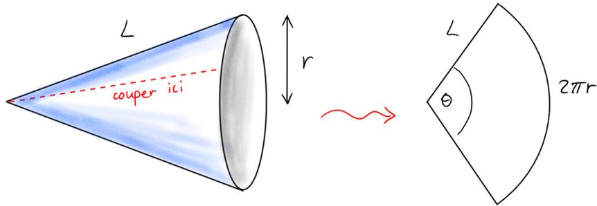
On a  $\theta \cdot L = 2\pi r$ , et donc  $\theta = \frac{2\pi r}{L}$ . L'aire de surface du cône est l'aire du secteur de rayon  $L$  et d'angle  $\theta$ , qui est donnée par
